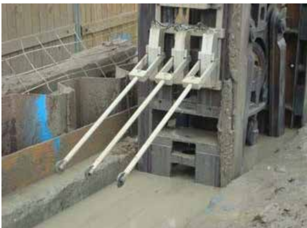
Hình 9: "Joint Inspector" với cảm biến khoảng cách
